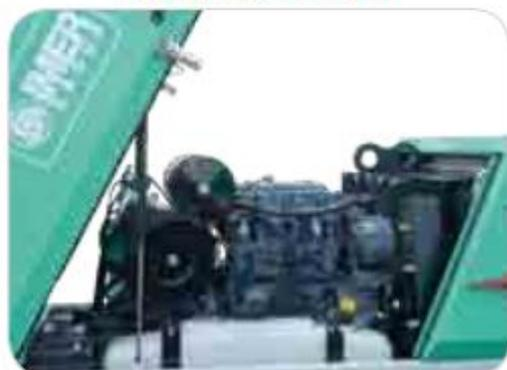
Motore diesel Kubota - 48,5 kw
